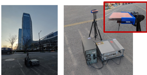
将小型地面站收发天线系统部署在地面，在高楼模拟卫星收发。经过验证，微软亚洲研究院团队设计的超表面能提升信噪比 6.8-45 倍。
